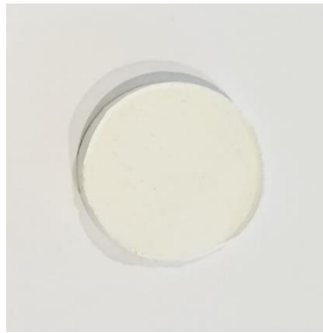
Фиг. 8 Образец от бариевотитанатна керамика
