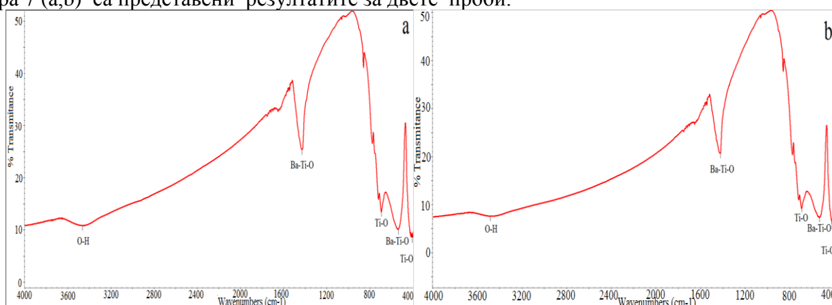
Фиг. 7 (a, b) FT-IR спектри на изходен прах от \text{BaTiO}_3 : а) състав №1; б) състав №2
