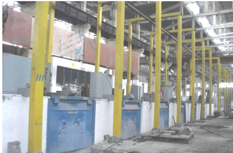
Фиг.1. Индукционни пещи за топене на алуминий.
