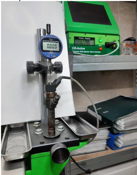
Фиг.2. Опитна уредба за измерване хода на клапана
