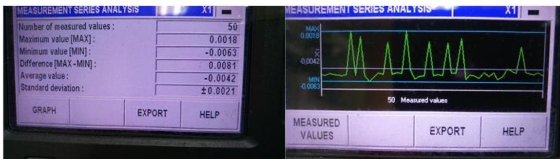
Фиг.7 Статистически анализ при образец медна сплав с мажещо-охлаждаща течност
