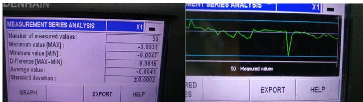
Фиг.3 Статистически анализ при образец медна сплав (числени и графични резултати)
