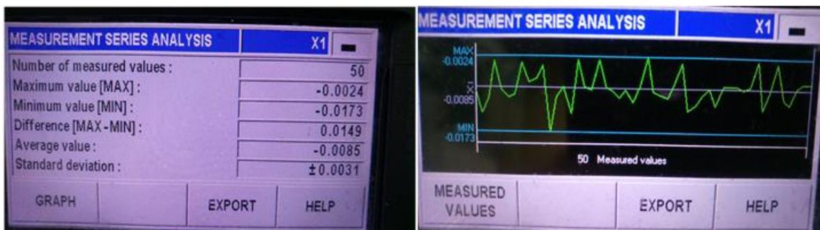
Фиг.6 Статистически анализ при образец желязна сплав с мажещо-охлаждаща течност
