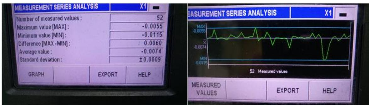
Фиг.5 Статистически анализ при образец желязна сплав (числени и графични резултати)
