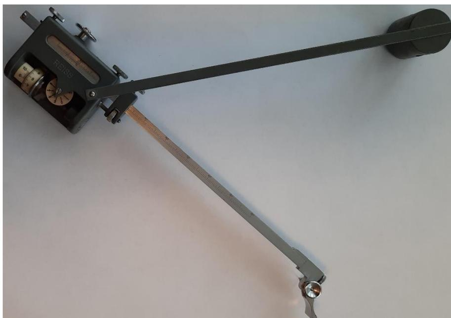
Фиг. 5. Планиметър за измерване площ на импулсите.
