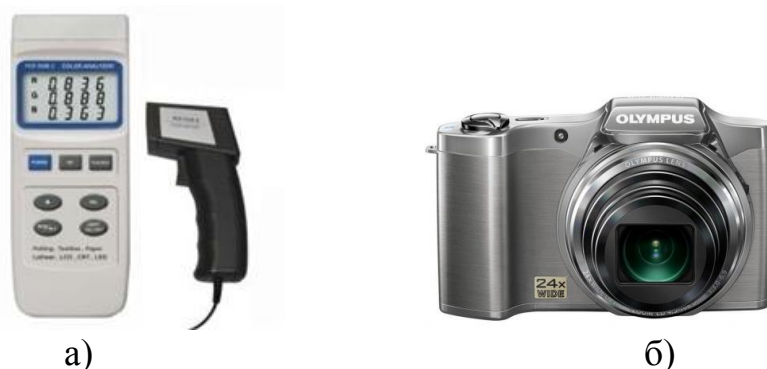
Фиг. 1. Уреди за получаване на цветови параметри на почва: а) ръчен спектрален измервател на цвят PCE-RGB2; б) цифров фотоапарат, модел Olympus SZ-14
