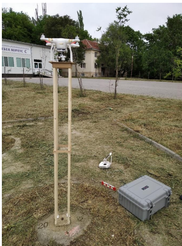
Фиг. 1. Общ вид на опитната постановка, използвана за оценка на интервала на корелация на стационарните случайни грешки при определяне координатите на проекционните центрове на снимките от бордовите ГНСС приемници на БЛА
