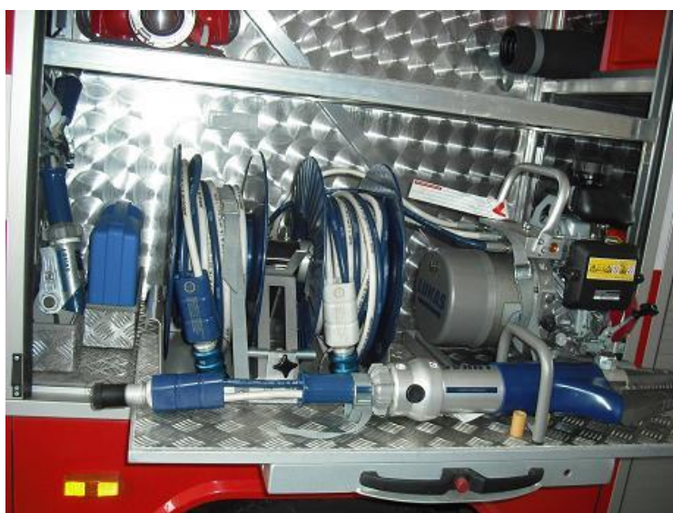
Фиг. 6 Хидравличен комплект за аварийно – спасителни дейности LUKAS P 620 SG
