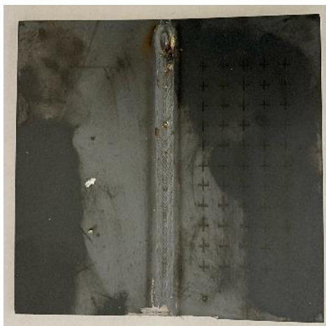
Фиг. 5 Фронтален изглед след заваряване
