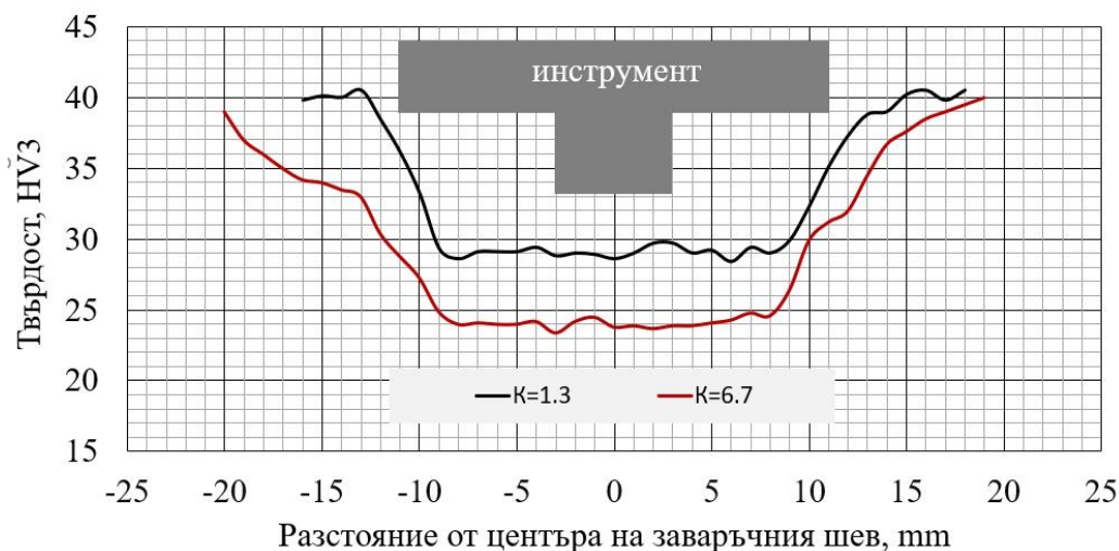
Фиг.3. Разпределение на твърдостта в заварените съединения при стойности на K=1.3 и K=6.7
