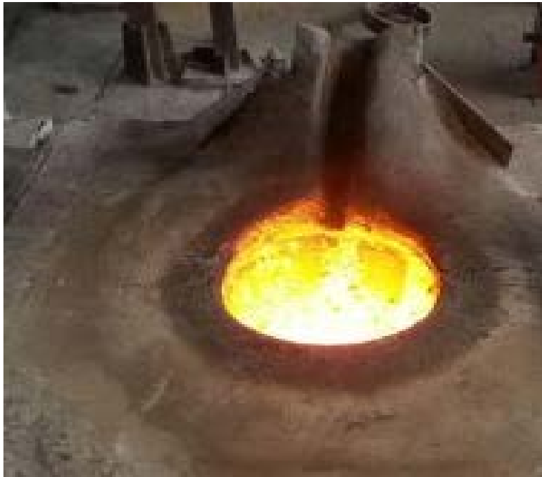
Фиг.1. Индукционна пещ в процес на топене.
