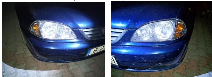
Фиг. 1 Пежо 307 с лампа с нажежаема жичка категория Н7 и пластмасов корпус на фар. (Автомобил А)
