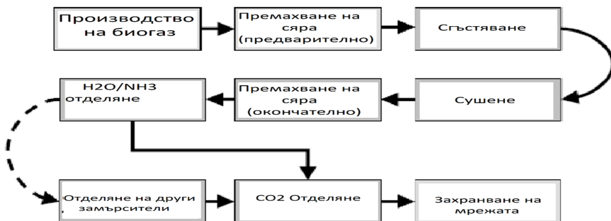
Фиг. 1. Основни стъпки на процеса по подобрене на биогазът необходими да се достигне желаното качество на газовият продукт.
