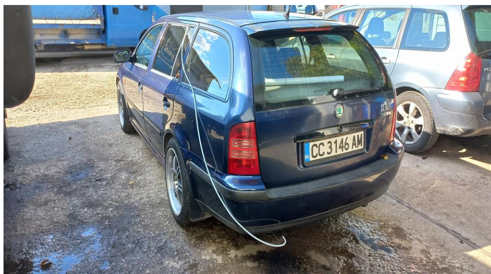
Фиг.3 Експерименталният автомобил с монтирана екипировка за дистанционно отчитане на азотните окиси по време на движение.
