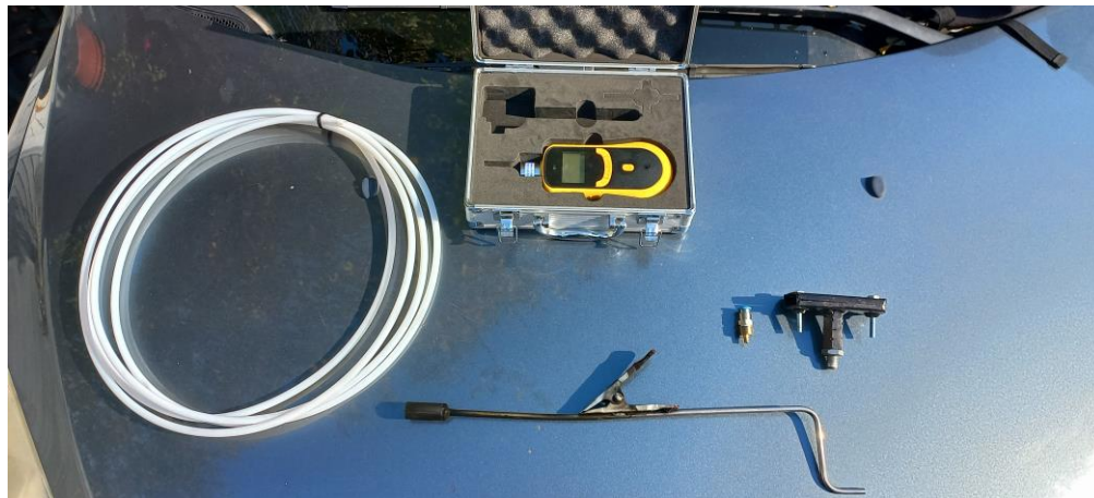
Фиг.2 Елементи на допълнителното оборудване, позволяващи монтажа на сондата към изпускателната система на експерименталния автомобил.
