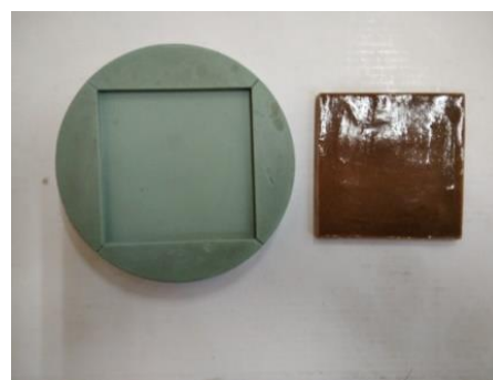
Фиг. 5. Пробно тяло, произведено от силиконовата матрица (от фиг. 4)
