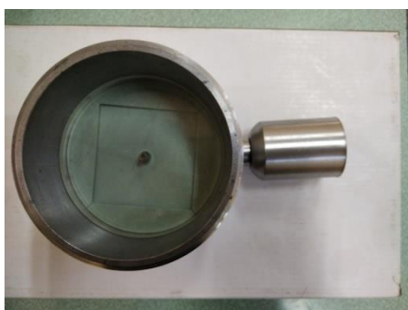
Фиг. 3. Силиконова матрица, намираща се в инструмента (от фиг. 2)
