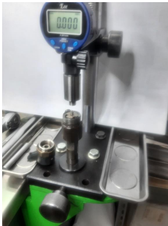
Фиг.2. Опитна уредба за измерване на въздушната хлабина между електромагнита и котвата на разтоварващия клапан
