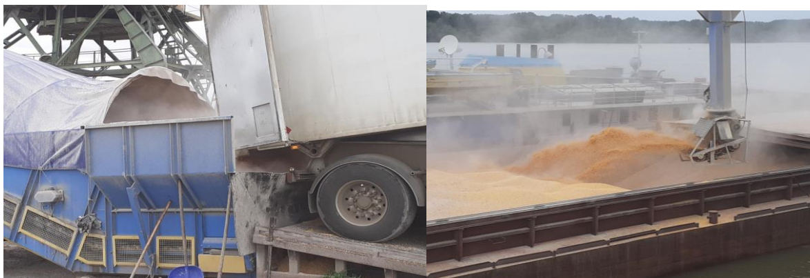
Фиг. 3 Директен способ на товаро-разтоварване с приемно устройство на мобилния корабен товарач и глава на мобилен товарч
