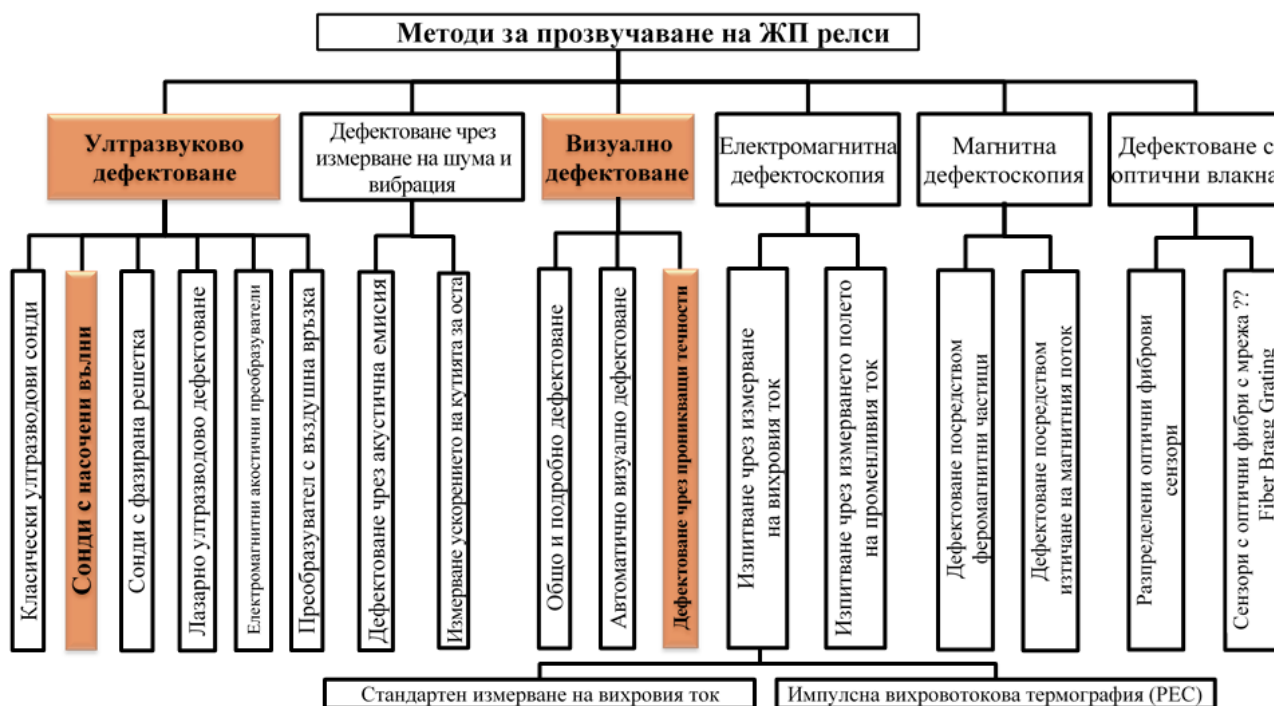
Фиг. 9. Методи за дефектоване на ЖП релси
