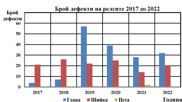
Фиг. 11. Видове дефекти на релсите във времето от 2017 до 2022
