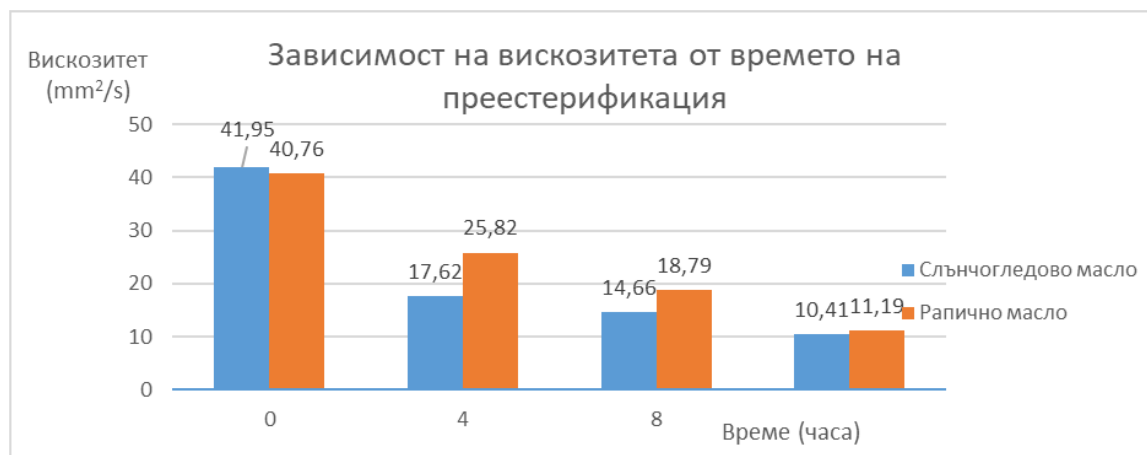
Фиг. 2. Зависимост на вискозитета от времето на преестерификация (катализатор сулфомаса)
