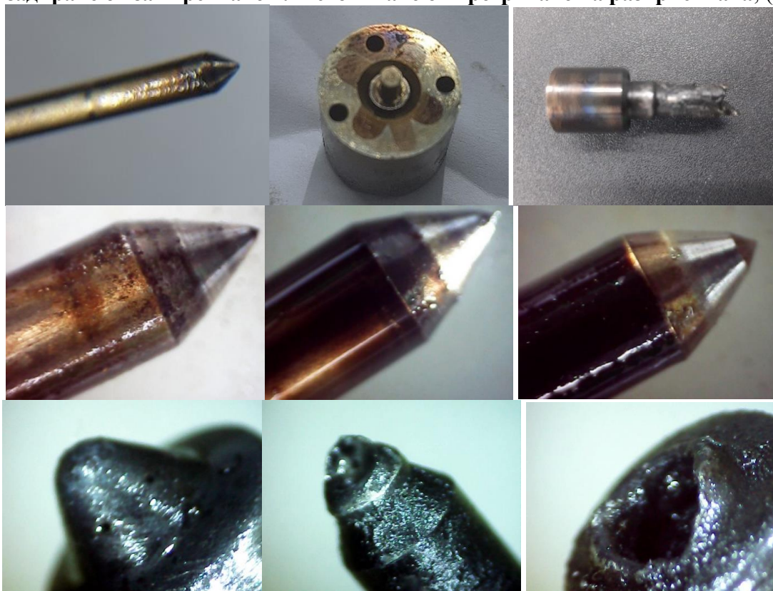
Фиг. 6. Замърсени и стопени разпръсквачи
