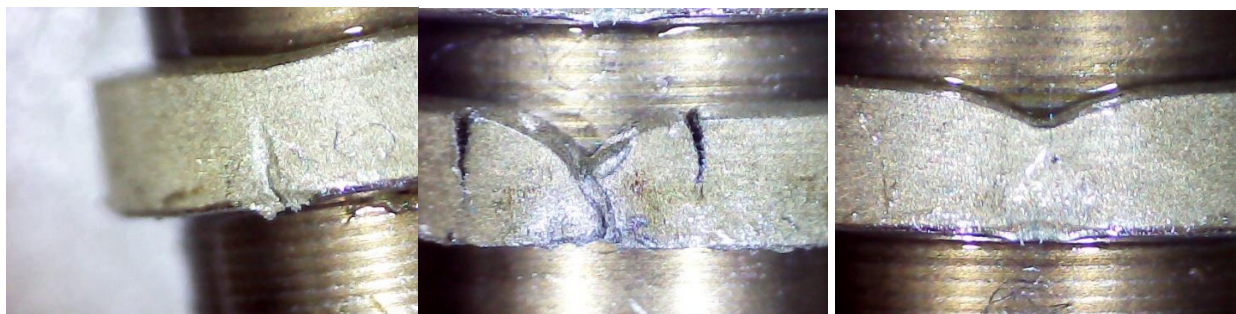
Фиг. 5. Повредено уплътнение на клапанното легло
