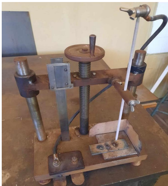
Фиг. 1. Приспособление на Хренов за определяне на стабилността на горене на дъгата
