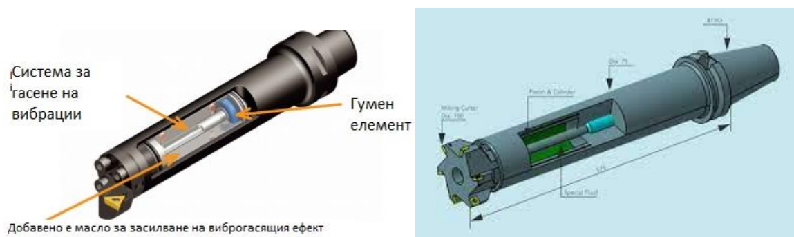
Фиг. 4. Инструмент с вградена в корпуса система за гасене вибрации.
