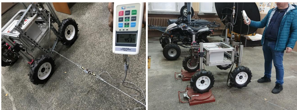
Фиг. 5. Опитно определяне на центъра на тежестта на селскостопански робот в лабораторни условия.
