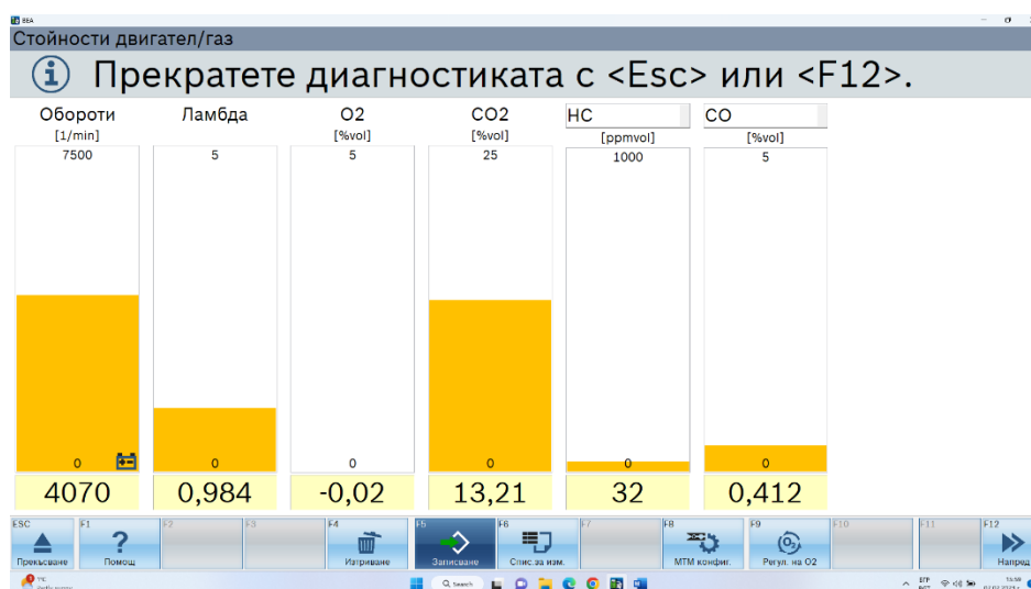
А) Работа на двигателя с пропан бутан при 4000 \text{ min}^{-1}
