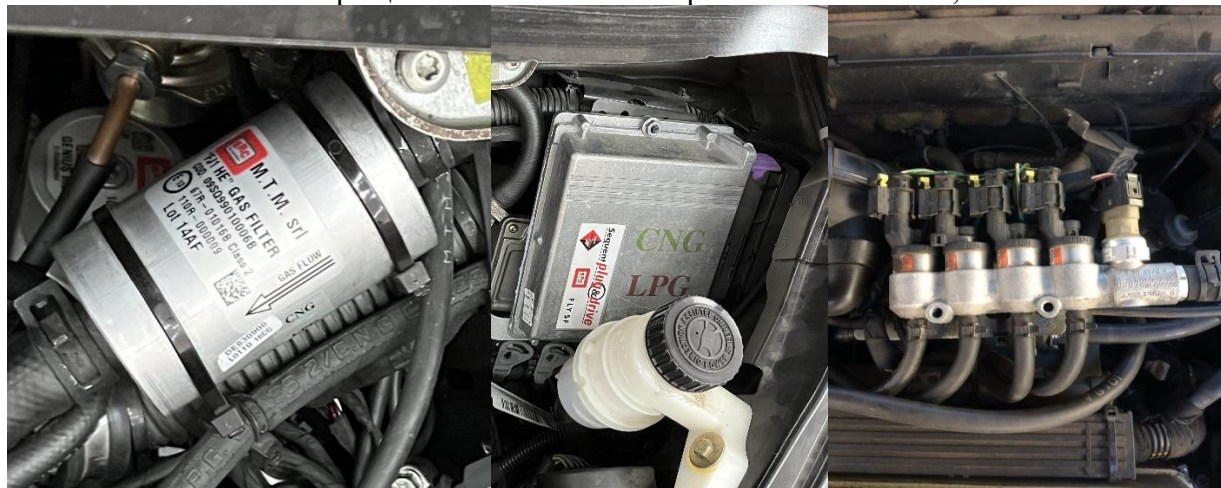
Фигура 4. Горивен филтър, блок за управление, рейл, гориво-впръсквачи и възприематели за температура и налягане.
