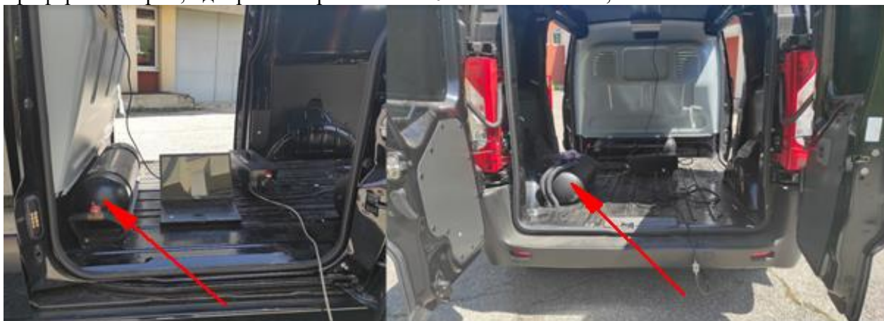
Фигура 1. Резервоари за газообразни горива – а) – резервоар за CNG; б) – резервоар за LPG.
