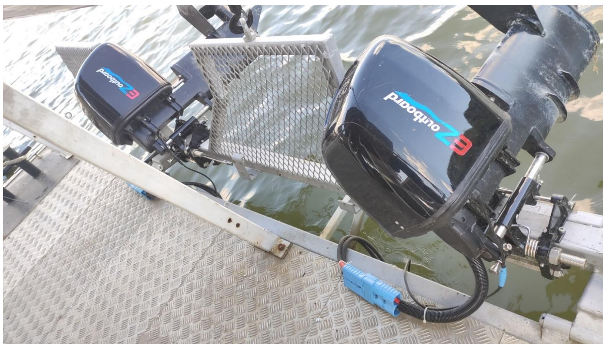
Фиг. 2. Електродвигатели Golden Motor EZ Outboard Sport 20HP, задвижващи плавателния съд HydRuForce
