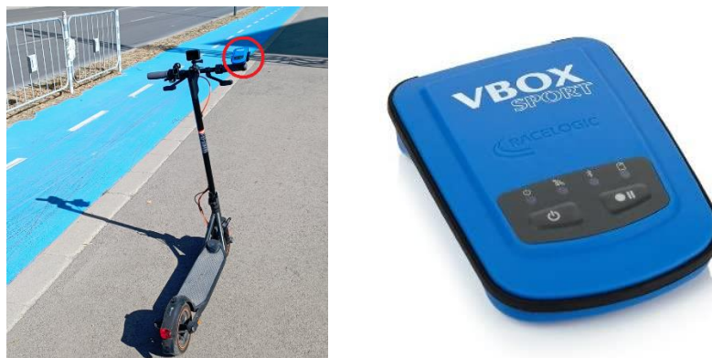
Фиг. 4. Индивидуално електрическо превозно средство и система Racelogic VBOX Sport
