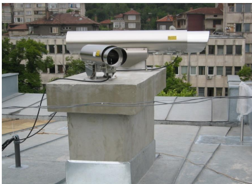
Фиг. 3. Снимка на ДОАС система – част от местна система за наблюдение и контрол на качеството на атмосферния въздух на Община Русе
