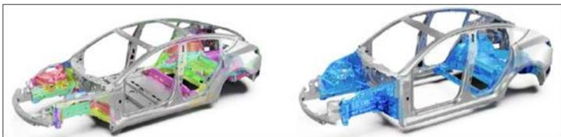
Фиг. 3 Илюстративна компановка на Модел 3 (в ляво), Модел Y (дясно). В дясно са показани в син маркер предна и задна част като единични цели отливки. В ляво чрез различни цветове са изобразени всички съставни части.
