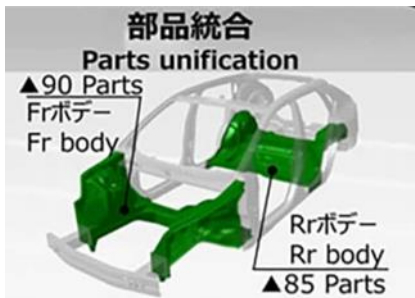
Фиг. 2. Илюстрация на маркирани в зелено отлети части. Посредством минимизирането на количеството детайли, които трябваше да бъдат отделени, са спестени 20 мин. от времето за монтаж. От Toyota също така имат за цел да постигнат 20% по-висока производителност спрямо конкурентите си благодарение на разработването и използването на свой софтуер за анализиране на оптималните условия на формоване.
