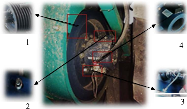
Фиг.3. Б) Конфигурацията на сензора за измерване на мощността на раздробяване включва следните основни компоненти: 1. еластична ролка; 2. монтажна основа; 3. сензор за въртящ момент; 4. сензор за скорост (Wang et al., 2023).
