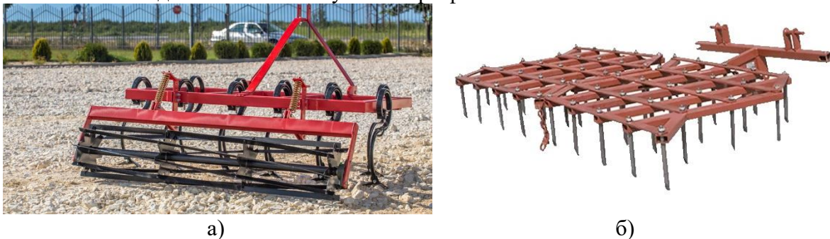
Фиг. 3. Култиватор за слята обработка с валяк (Skytrak, 2024) а), Зъбната брана БТ-1.6 на фирма Беларус (Belarusagro, 2024) б).
