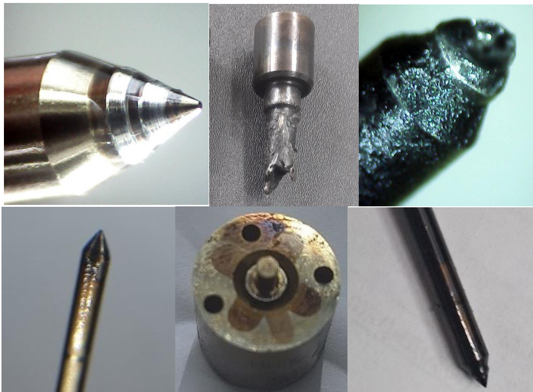
Фиг. 8. Замърсени и стопени разпръсквачи
