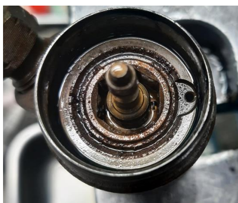
Фиг.2. Замърсена електромагнитна дюза
