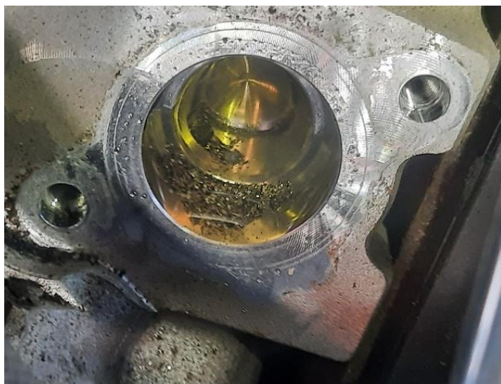
Фиг.5. Замърсен горивен колектор
