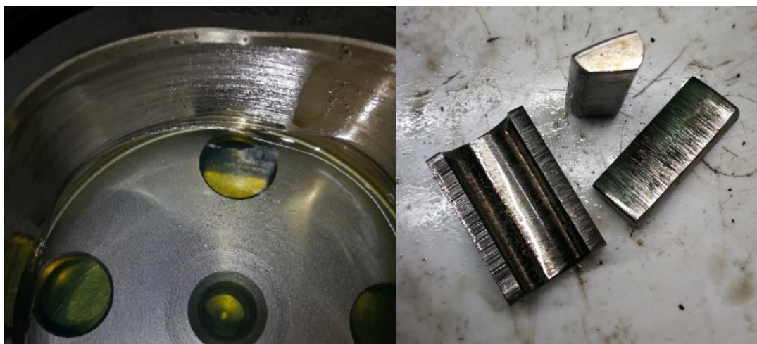
Фиг.4. Износена CR помпа Delphi - секция високо налягане
