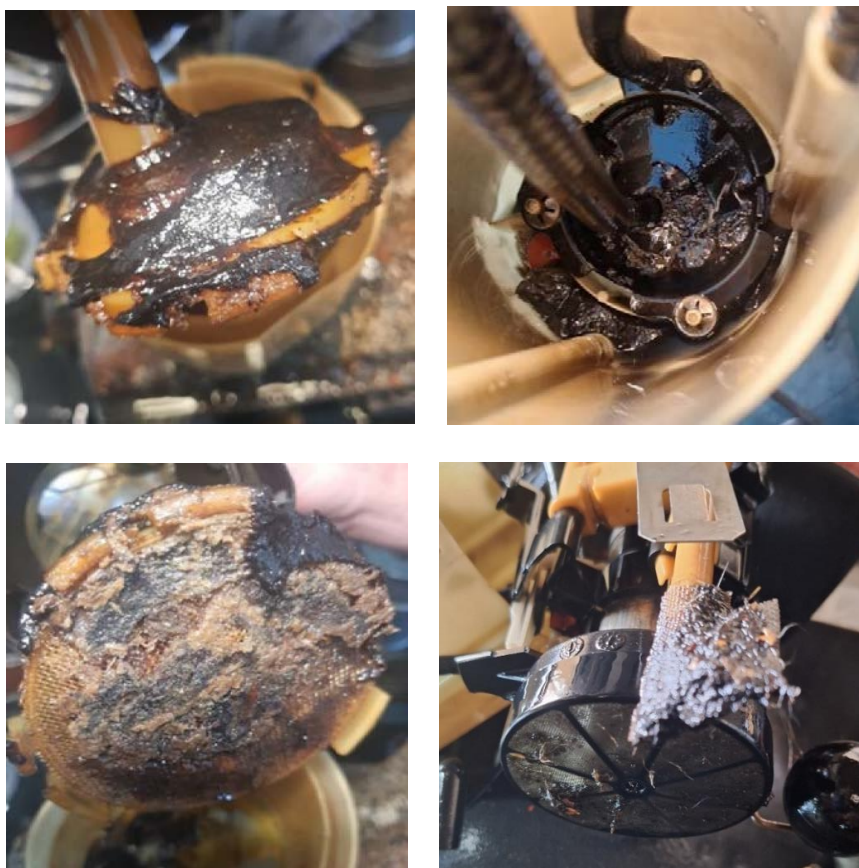
Фиг.1. Замърсени и задръстени сонди
