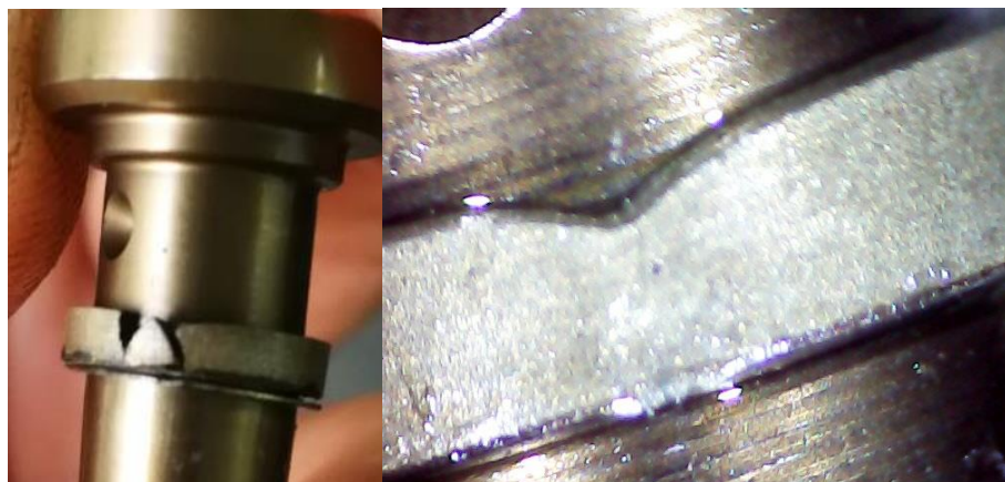
Фиг. 9. Повредено уплътнение на клапанното легло
