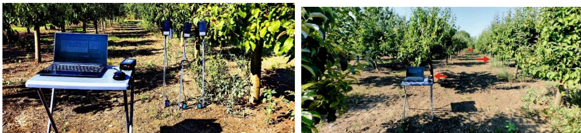
Фиг. 1. IoT слейв и мастер електронни модули и управляващ компютър, разположени в ябълкова градина
