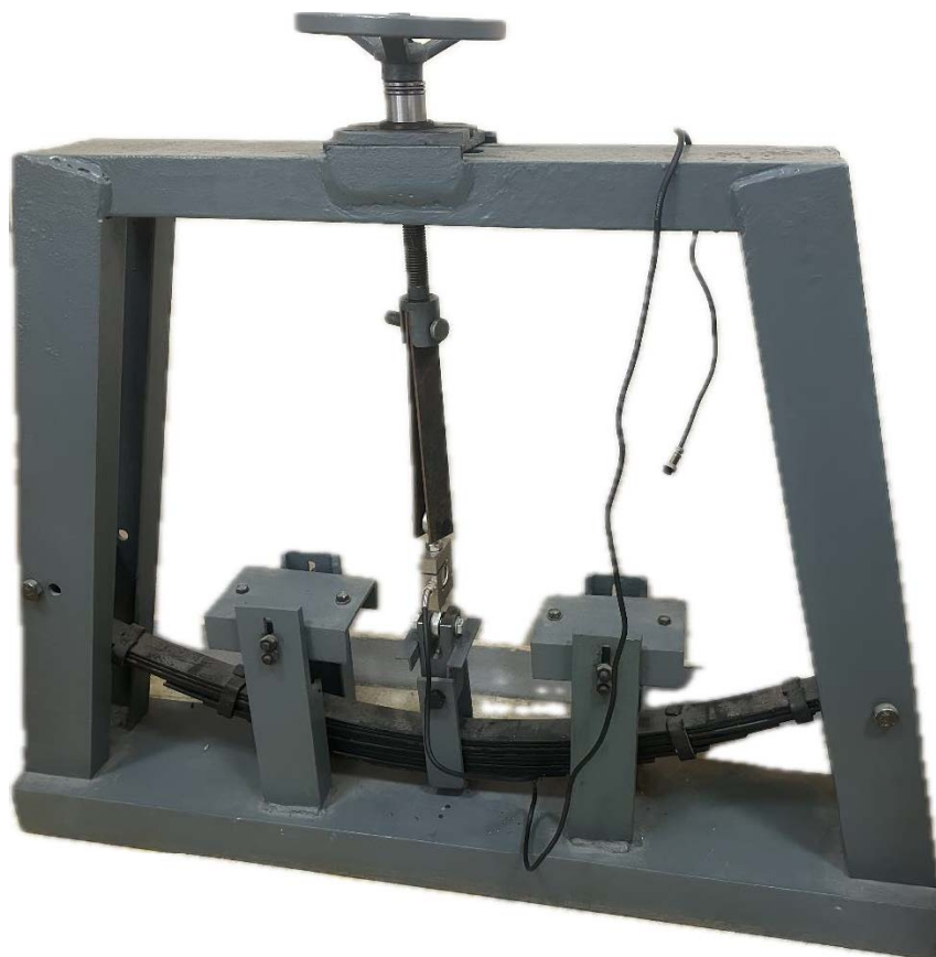
Фиг. 1. Опитна уредба за определяне на някои характеристики на еластичните елементи на окачването
