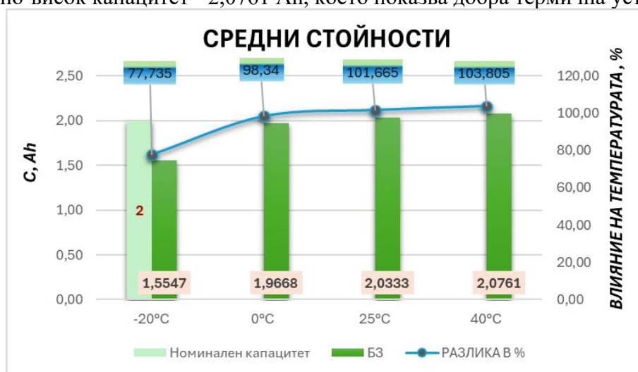
Фиг. 7. Разрядни профили на ЛИБ 3 при различни температури
