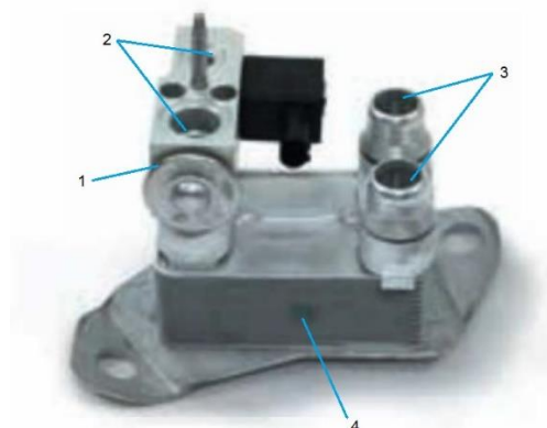
Фиг. 2. Теплообменник (Чилър)
