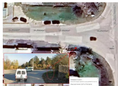
Фиг. 1. Пример за нарушено минимално разстояние за видимост ( D_{\min}=100\text{м} при V=50\text{км/ч} ).
