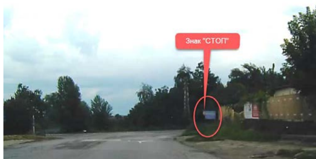
Фиг. 1. Пример за нарушено минимално разстояние за видимост ( D_{\min}=100\text{м} при V=50\text{км/ч} ).
