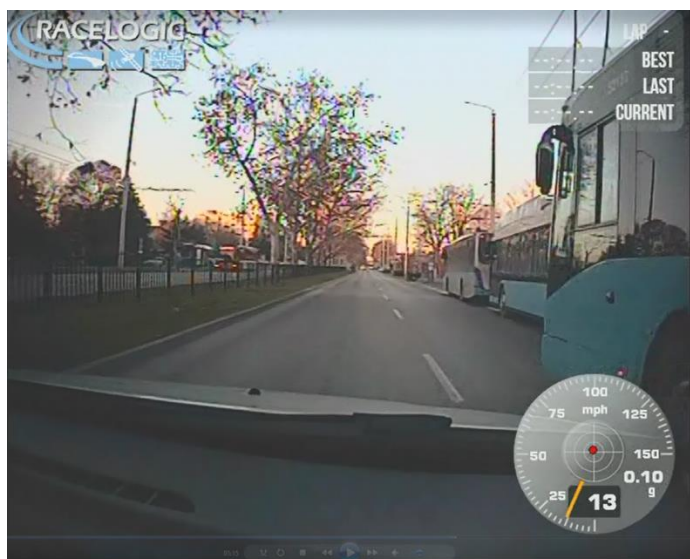
Фиг. 6. Недостатъчно уширение на платното за движение предвидено за автобусна спирки
