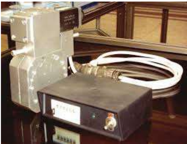
Фиг. 5. Разходомер РТГ-2 за оценка разхода на гориво на МТА
