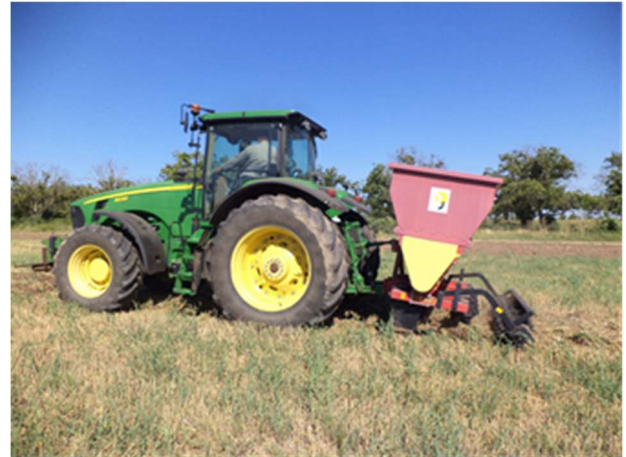
Фиг. 2. Устройство за внасяне на органично вещество в почвата
