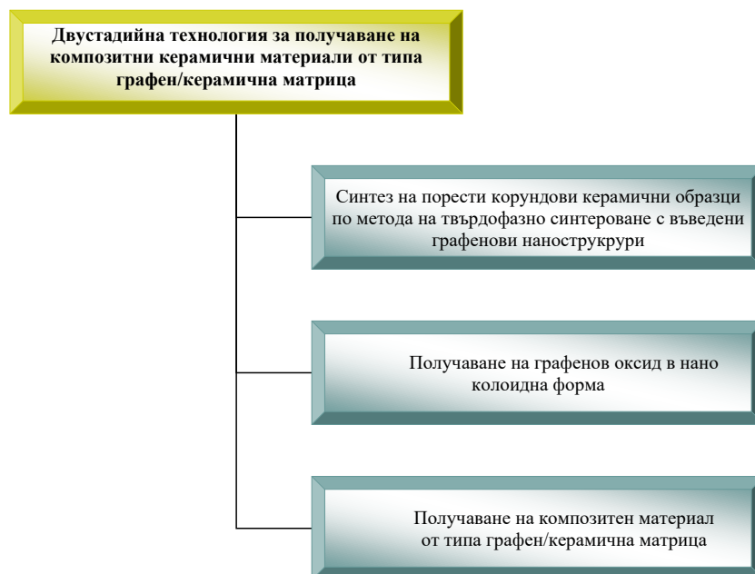
Фиг. 2 Етапи на получаване на композитни керамични материали от типа графен/керамична матрица
