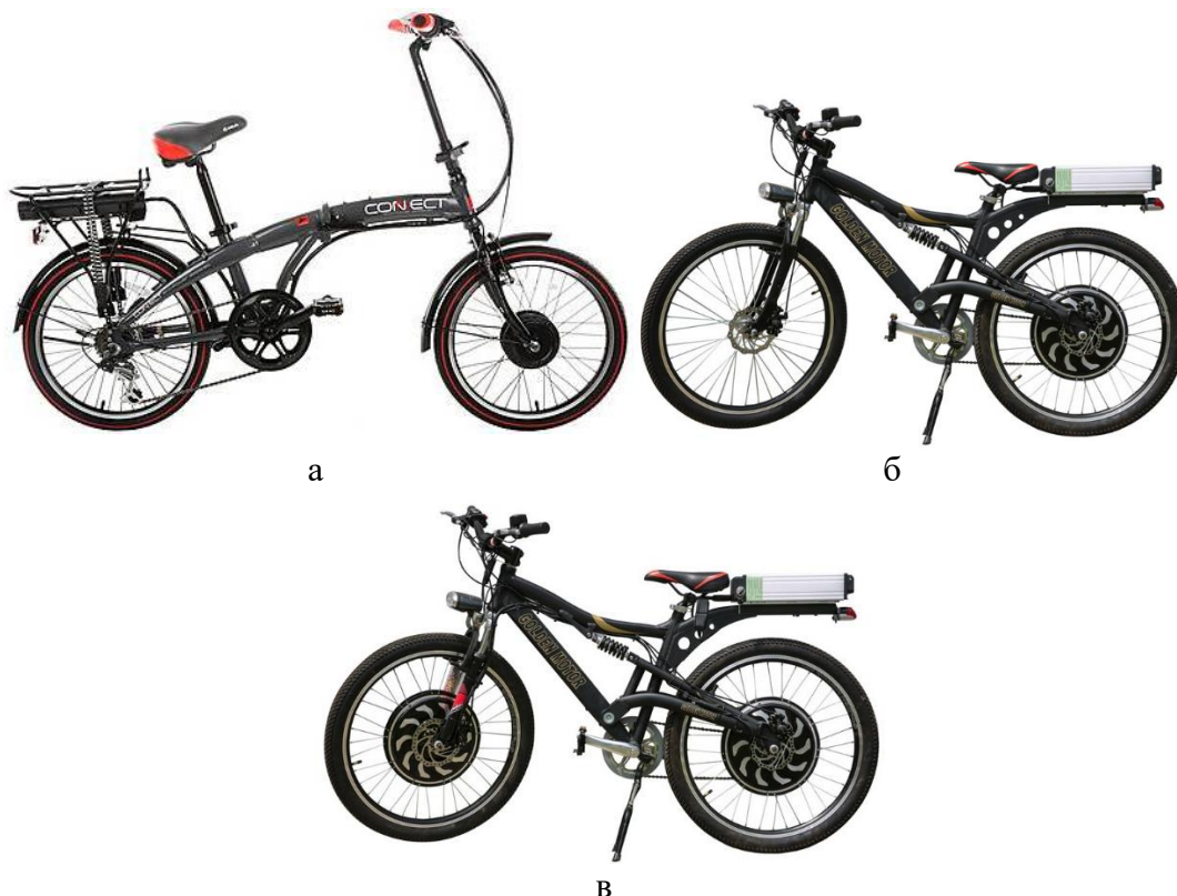
Фиг. 4. Общ вид на електровелосипеди с мотор-колела: а – предното колело задвижващо; б – задното колело задвижващо; в – двете колела задвижващи
