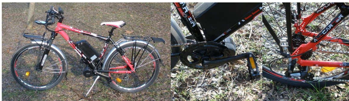
Фиг. 5. Електровелосипед с електродвигател, монтиран в централното задвижване
