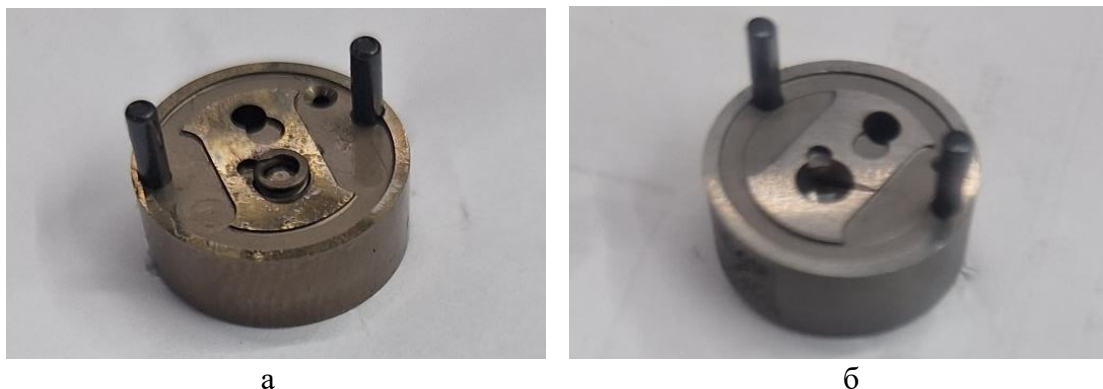
Фиг. 4. Замърсен и износен (а) и дефектен (б) клапан за излишно гориво
