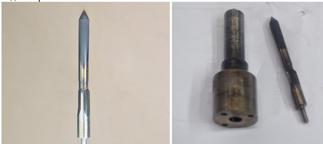
Фиг. 3. Износени и замърсени разпръсквачи
