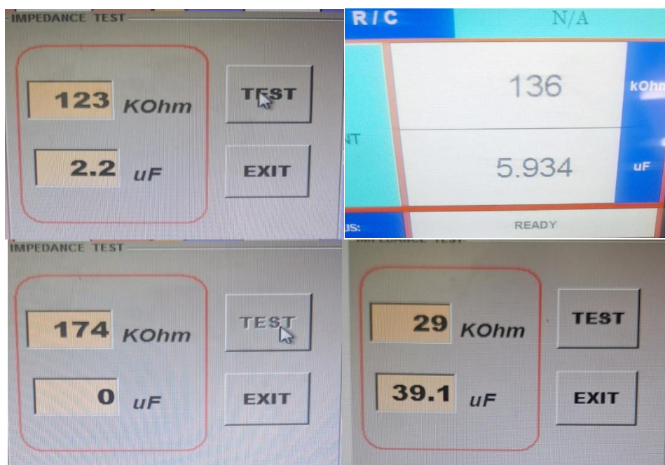
Фиг. 6. Неизправен пиезоелектрически задвижващ механизъм
