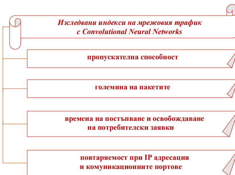
Фиг. 6. Изследвани индекси на мрежовия трафик с приложение на Convolutional Neural Networks
