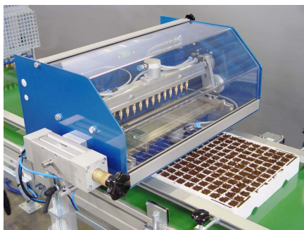
Фиг. 4 Сеялка за различни видове семена
