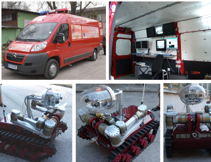
Фиг.1 Мобилен робот за обезвреждане на армейски и импровизирани взривове и спасителни операции
