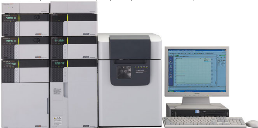
Фиг. 2. Хроматографски анализатор с компютърно управление
