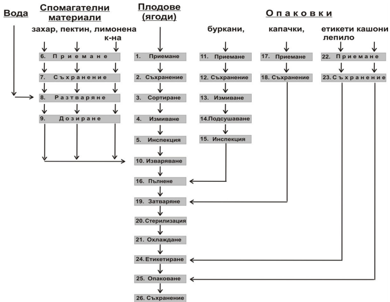
Фиг.1 Техноλογична схема за производство на конфитур от ягоди
