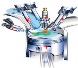
Фиг.1. Двигател с директно впръскване на горивото
