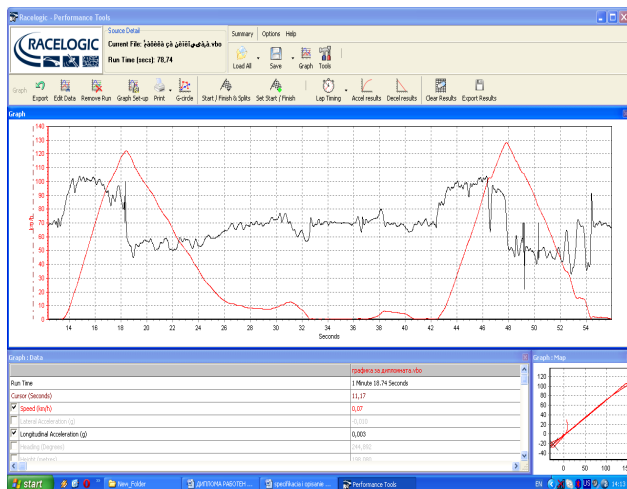
Фиг.1 Част от записа на скоростта и ускорението на мотоциклета със системата VBOX 3i.
