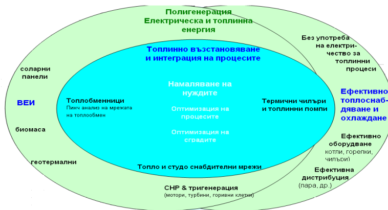
Фиг.1. Цялостен подход за топлинноенергиен одит – поглед през “око” на „Einstein”. (ВЕИ – възобновяем източник на енергия, СНР – комбинирано производство на електроенергия и топлина, когенерация)
