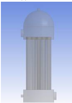
Фиг.1 Геометричен модел на вертикален тръбен абсорбер
