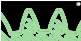
Фиг. 3 Формиране на единичен слой от прототип на зъбно колело с модул  $m=1$  и брой зъби  $z=52$
