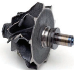
Фиг.5 Разрушен вал на турбокомпресор.
