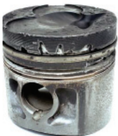
Фиг.5 Повредено чело на буталото от разрушени бутални пръстени.
