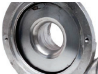
Фиг.2 Дефекти по корпуса на турбокомпресора
