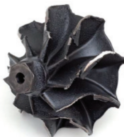
Фиг.8 Разрушена турбина на турбокомпресора
