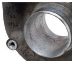
Фиг.12 Следи от абразивно износване на смукателната част на турбокомпресора
