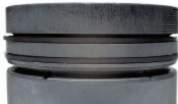
Фиг.8 Осево износване на канала за буталните пръстени
