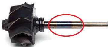
Фиг.3 Износен вал на турбокомпресор.
