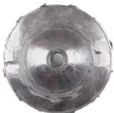
Фиг.15 Деформирана турбина
