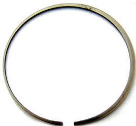
Фиг.7 Радиално износване на бутален пръстен.
