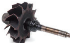
Фиг.9 Нагар по вала на турбината на турбокомпресора
