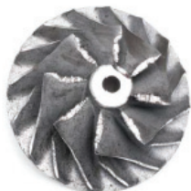
Фиг.11 Износени лопатки на турбината на турбокомпресора
