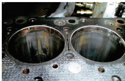
Фиг.2 Следи от задиране в цилиндровите отвори.
