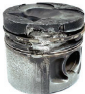
Фиг.4 Полирана зона на бутален пръстен
