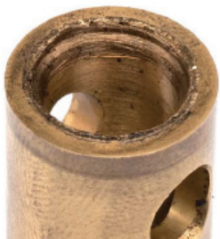
Фиг.7 Следи от абразивно износване в радиалния плъзгащ лагер.
