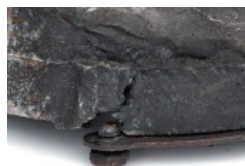
Фиг.14 Пукнатина в корпуса на турбокомпресора
