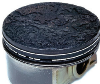
Фиг.6 Разрушен бутален пръстен
