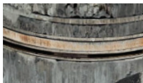
Фиг.10 Бразди и прегрявания на буталния пръстен
