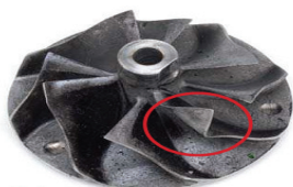
Фиг.13 Деформирана лопатка на турбокомпресора
