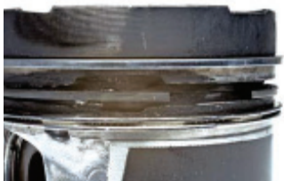
Фиг.3 Износени канали на буталните пръстени.
