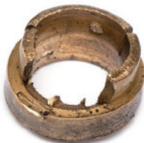
Фиг.6 Разрушен лагер на турбокомпресора
