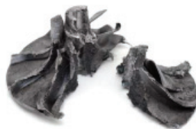
Фиг.16 Разрушена турбина
